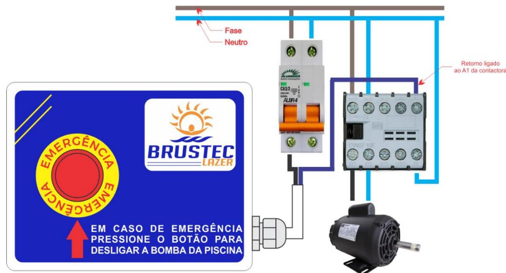
**ACONSELHAMOS A INSTALAÇÃO DESTE EQUIPAMENTO EM LOCAL ABERTO E PROTEGIDO DA CHUVA, PRÓXIMO DA PISCINA DE ACORDO COM AS NORMAS 10.339; NBR 5410 E NR12.**
