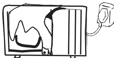
! Quando a unidade estiver em funcionamento, nunca cobrir com roupas, sacos plásticos ou qualquer outro material que bloqueie a ventilação do produto, que pode levar a baixa eficiência ou não funcionamento do mesmo.
