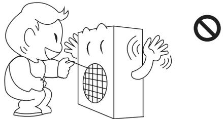
Não toque na saída de ar quando o motor estiver em funcionamento.
