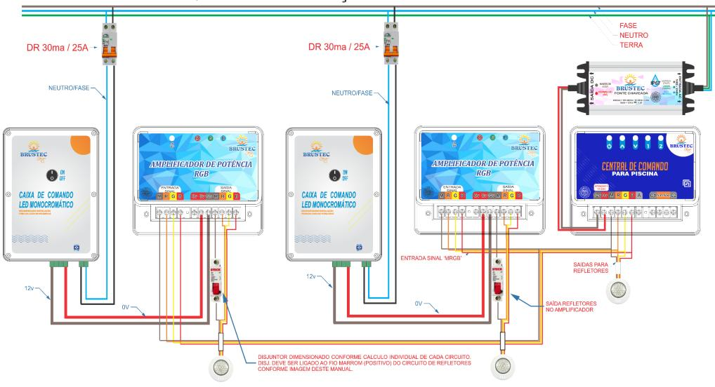
OBS: NECESSARIO INSTALAÇÃO DE DISJUNTOR NO FIO POSITIVO DO CIRCUITO QUE ALIMENTA OS REFLETORES, PARA GARANTIA TOTAL QUE NÃO HAVERA DANOS NAS INSTALAÇÕES E EQUIPAMENTOS. DISJUNTOS DEVE SER DIMENSIONADO CONFORME CARGA DO CIRCUITO E O LIMITE DE CORRENTE DO CABO ELÉTRICO.
