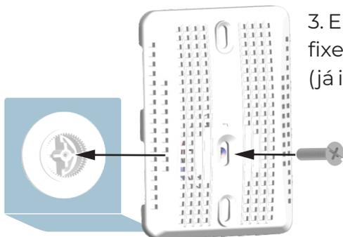
3. Encaixe a tampa e fixe com o parafuso (já incluso).
