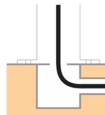
1. Instale um eletroduto, conduite até o local de instalação da torre e se possível uma caixa passagem, conforme imagem ao lado, e seguindo a norma NR 12. Então passe um cabo para ligar ao botão de emergência.
