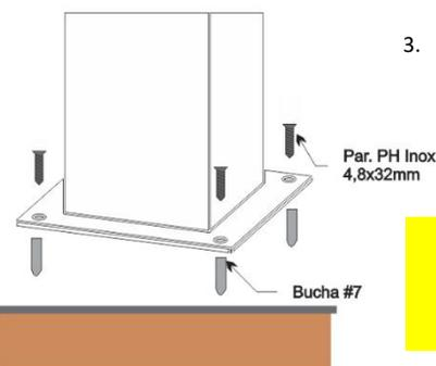
3. Fixe a torre de emergência utilizando as buchas e parafusos.
