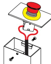
2. Conecte os cabos elétricos ao contato NF do botão de emergência, conforme imagem ao lado.
